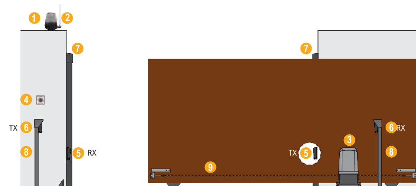
1_Lampeggiatore 2_Antenna da esterno 3_Motoriduttore con centrale e ricevitore radio 4_Selettore a chiave 5_Fotocellule CHIUSURA 6_Fotocellule APERTURA 7_Bordo sensibile 8_Colonnina fotocellule 9_Catena
